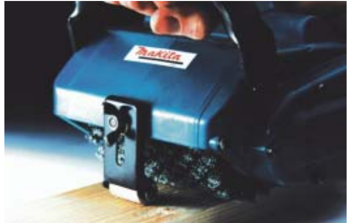
Strukturieren von Hart- und Weichholz. Structuring hard and soft woods.
