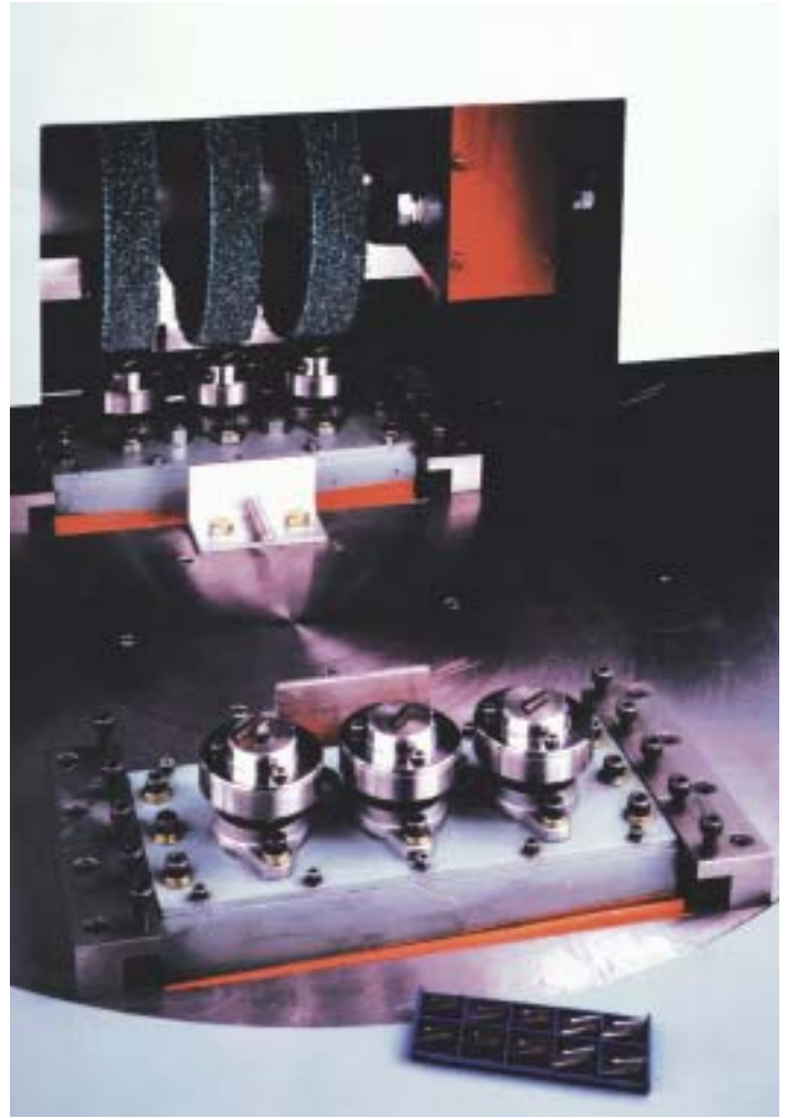
Entgraten von Hartmetall- oder Keramik-Wendeplatten. Deburring of hard metal or ceramic turnplates
